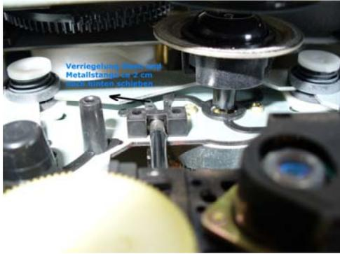
5. Verriegelung der Führungsstange mit einem kleinen Schraubendreher lösen und sie ca. 2cm nach hinten schieben.
