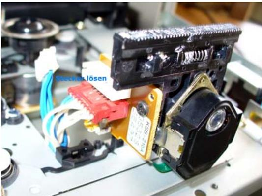
7. Nun die Steckkontakte lösen und die alte Lasereinheit gegen die neue ersetzen.
