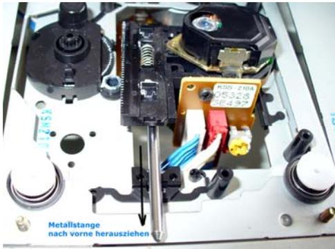
5. Anschließend die Führungsstange über die vordere Arretierung heben und vorsichtig herausziehen.
