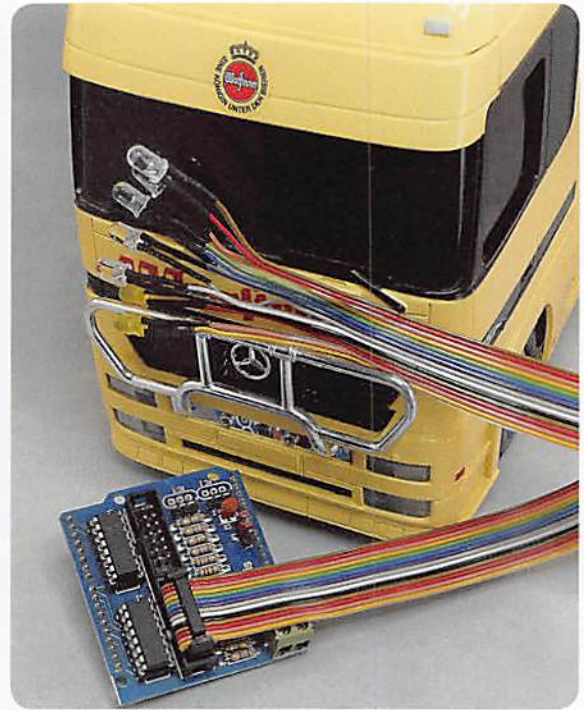
Bild 11: Mit den Mitteln des Lernpakets lässt sich u. a. eine komplett funktionsfähige Modellbau-Fahrzeugbeleuchtung realisieren, hier für die Fahrzeugfront.
