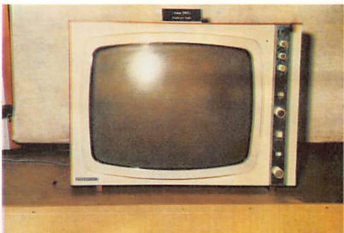
Bild 5: Implisionsgeschützte 47-cm-Bildröhre und die Standardkonzeption II waren Merkmal des Gerätes „Ines 1001“ von 1967
