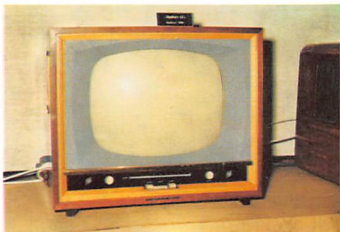
Bild 2: Schon für UHF-Empfang vorbereitet war der Fernsehempfänger „Staßfurt 43 TG 501“, dessen Produktion 1960 begann
