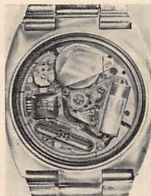
Bild 2: Elektronisches Quarzchronometer mit diskreten Bauelementen (Longines)
