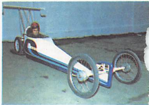
Дрегстер «ХАДИ-24». Двигатель одноцилиндровый, с рабочим объемом 500/750 см 3 , мощностью 75/80 л. с. Прочие характеристики: база — 3300 мм, передняя колея — 1000 мм, задняя колея — 375 мм, высота по кабине — 840 мм, клиренс — 23 мм, масса в снаряженном состоянии — 120 кг, скорость (расчетная) — 280 км/ч.
