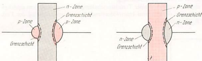
Bild 3.1. Leitfähigkeitstypen pnp- und npn-Transistor
