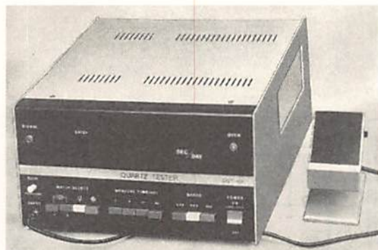
Bild 8.2. Gangkontrollgerät mit Mikrofon zur visuellen Gangkontrolle
